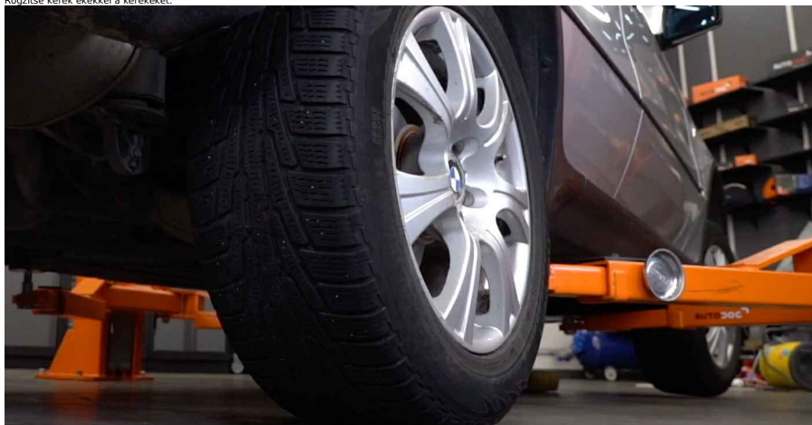
6 Lazítsa meg a kerékrögzítő csavarokat. Használja a következő kerék dugókulcsot: 19.
