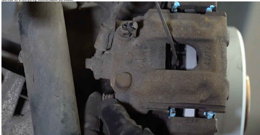
24 Szerelje be a féknyereg visszahúzó rugót.
