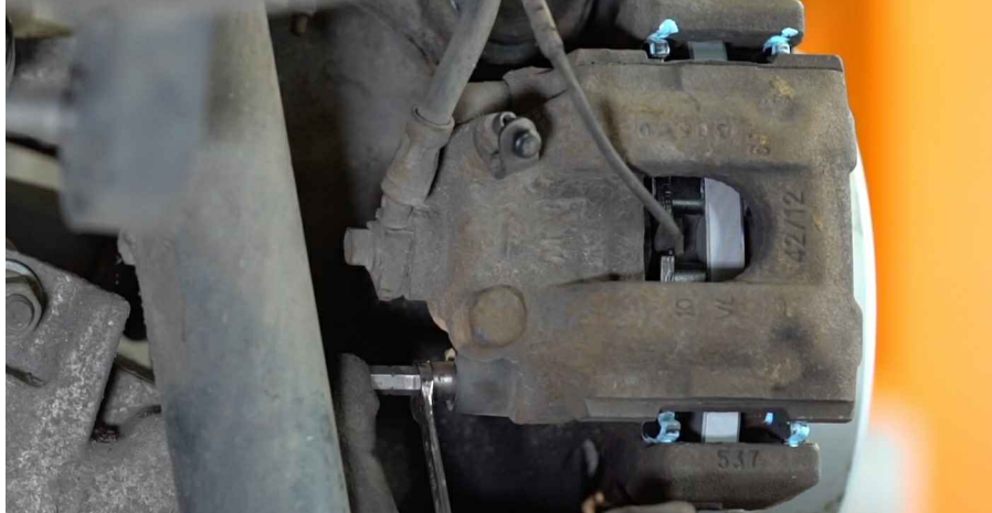
23 Szerelje fel a féknyereg vezetőcsapok porvédőit.
