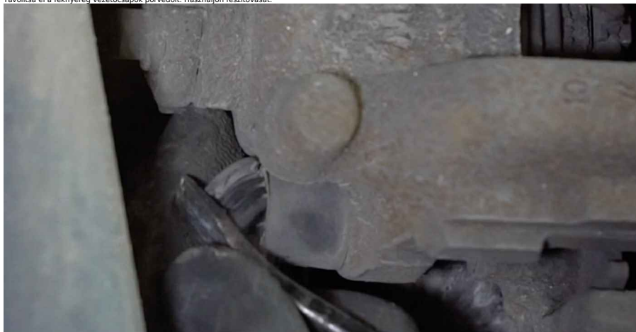
12 Csavarja ki a féknyereg rögzítőt. Használjon H7-as imbuszkulcsot. Használjon racsnis kulcsot.
