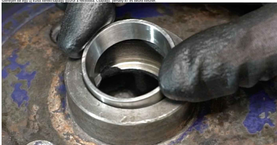
19 Szerelje be a kerékcsapágy új belső menetét a fékdobba. Csapágy, persely ki- és beütő készlet.
