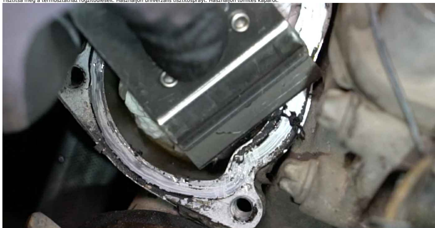
25 Szerelje be az új termosztátházat a termosztáttal együtt.
