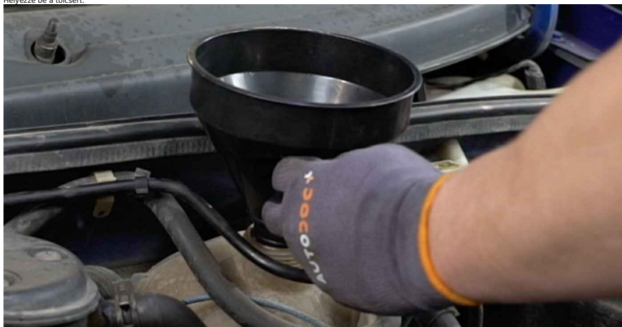
35 Töltsön hűtőfolyadékot a hűtőfolyadék tartályba.
