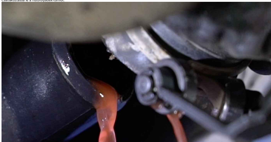
8 Csatlakoztassa le a hűtőfolyadék-töltőt.
