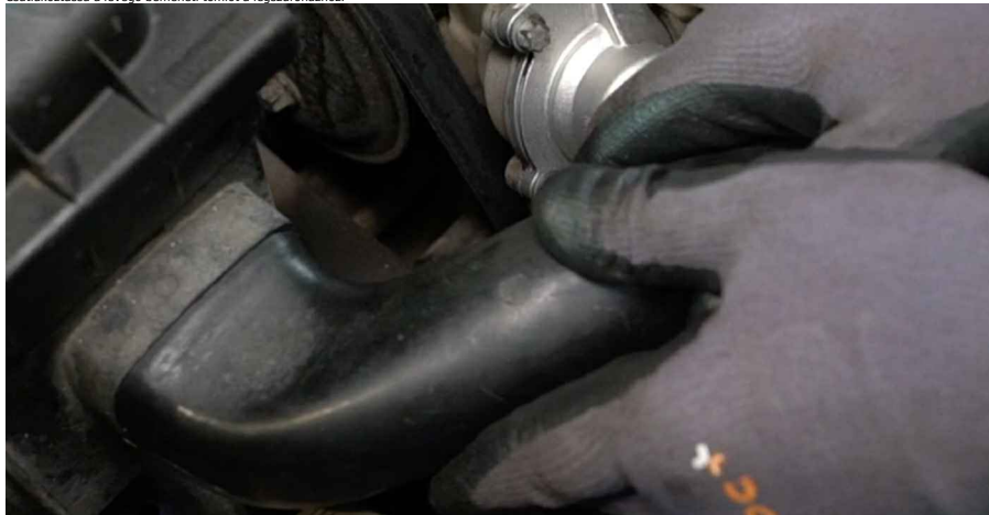
32 Csatlakoztassa a légszűrő beszívótömlőjének kapcsát.
