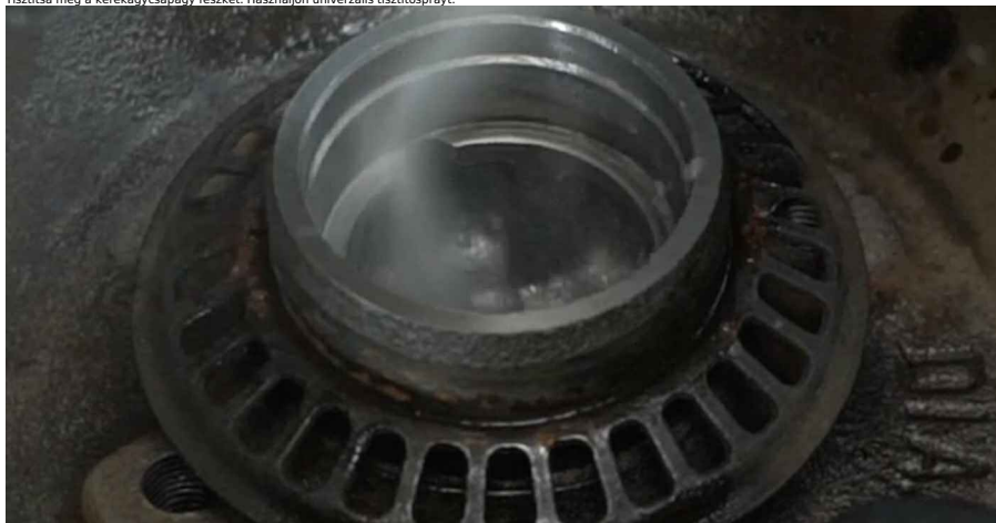
18 Szereljen be egy új külső kerékcsapágy gyűrűt a fékdobba. Csapágy, persely ki- és beütő készlet.
