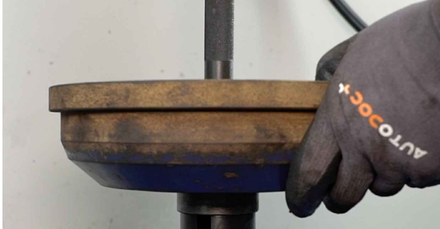
17 Tisztítsa meg a kerékcsapágy fészkét. Használjon univerzális tisztítósprayt.
