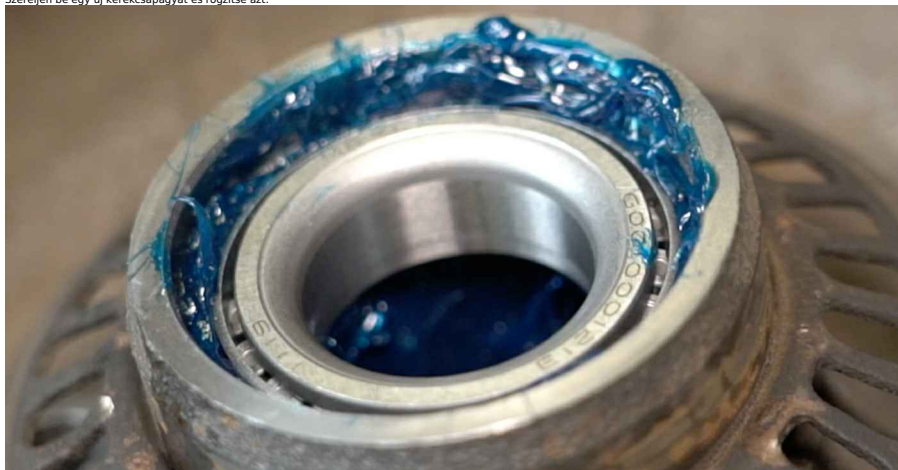
22 Szerelje fel a kerécsapágy tömítőgyűrűjét.
