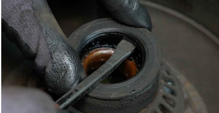
13 Vegye le a kerékcsapágot. Használjon feszítővasat.
