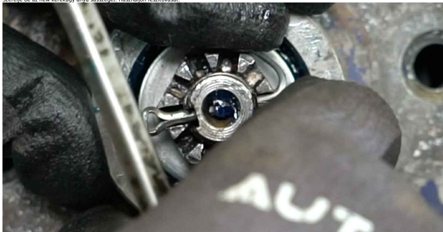
34 Tegye fel a kerékanya kupakját. Használjon gumikalapácsot.
