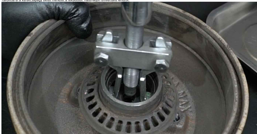
15 Távolítsa el a kerékcsapágy belső menetét a fékdobtól. Használjon univerzális lehúzó.
