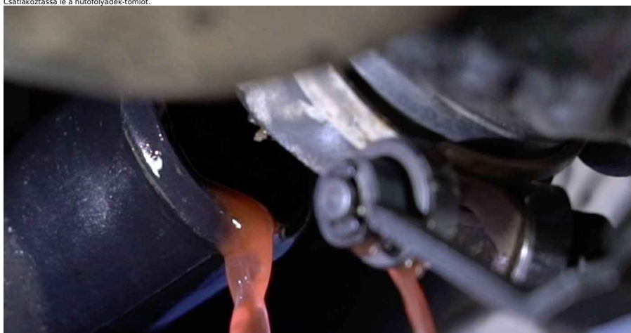
8 Csatlakoztassa le a hűtőfolyadék-töltőt.
