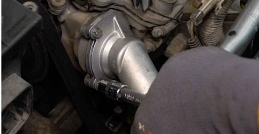
28 Csatlakoztassa a hűtőfolyadék-tömlőt.
