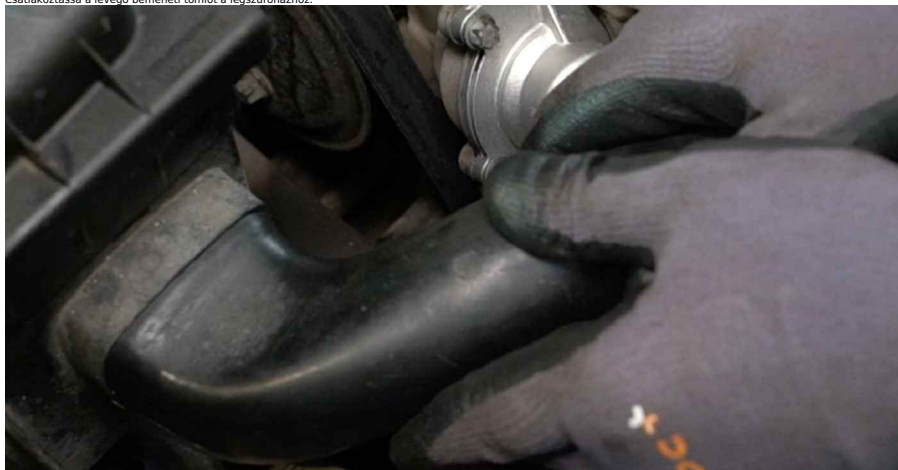
32 Csatlakoztassa a légszűrő beszívótömlőjének kapcsát.
