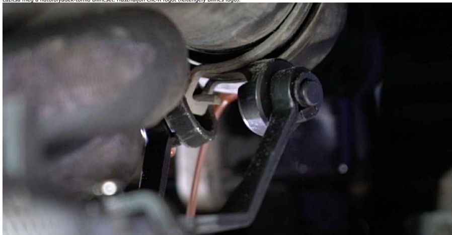
8 Csatlakoztassa le a hűtőfolyadék-töltőt.
