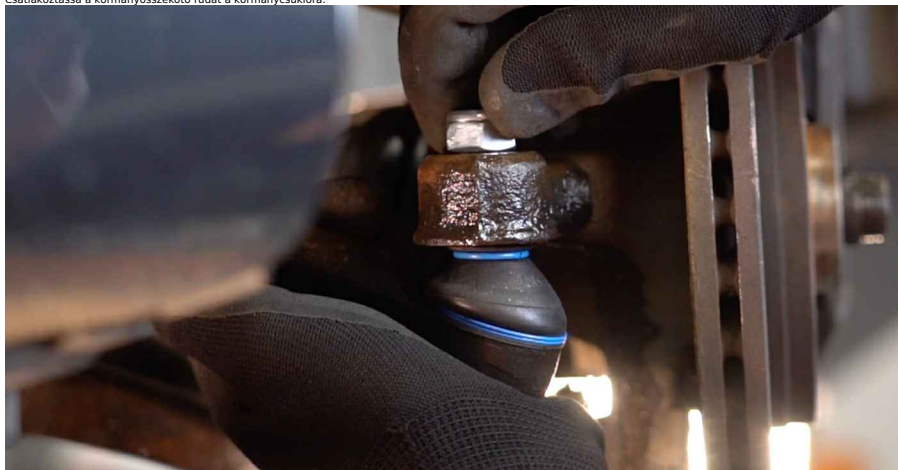
18 Húzza meg a kormányösszekötő rúd fejet a tengelycsukkkal összekötő rögzítőanyát. Használja a következő méretű csavarbehajtó fejet: 17. Használjon nyomatékkulcsot. Húzza meg 33 Nm nyomatékkal.
