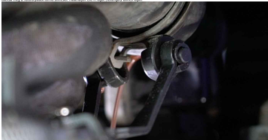
8 Csatlakoztassa le a hűtőfolyadék-töltőt.
