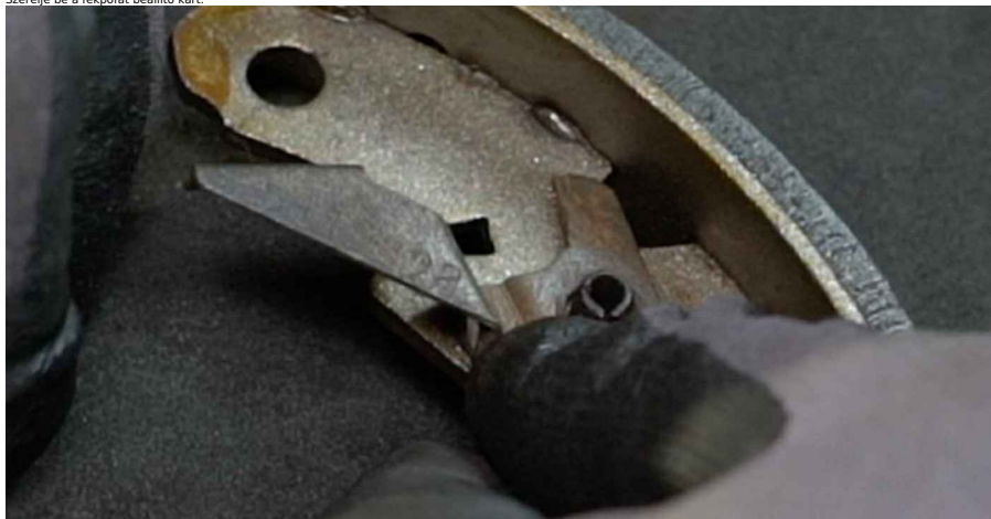
34 Szerelje fel a rugós biztosítógyűrűt.
