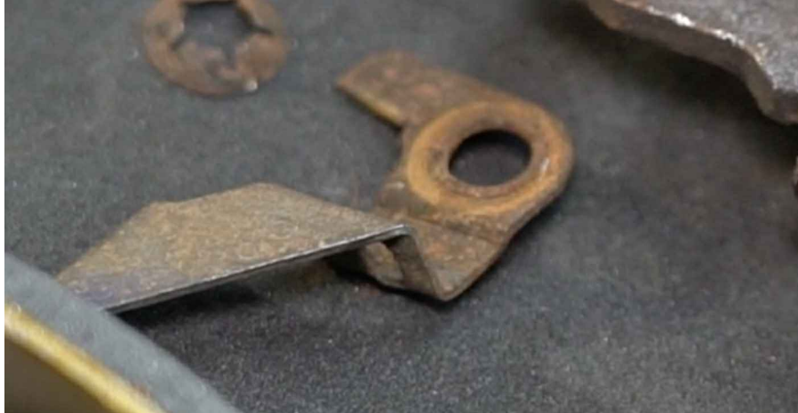
29 Tisztítsa meg a persely rögzítési helyét. Használjon drótkéfért. Használjon WD-40 spray-t.
