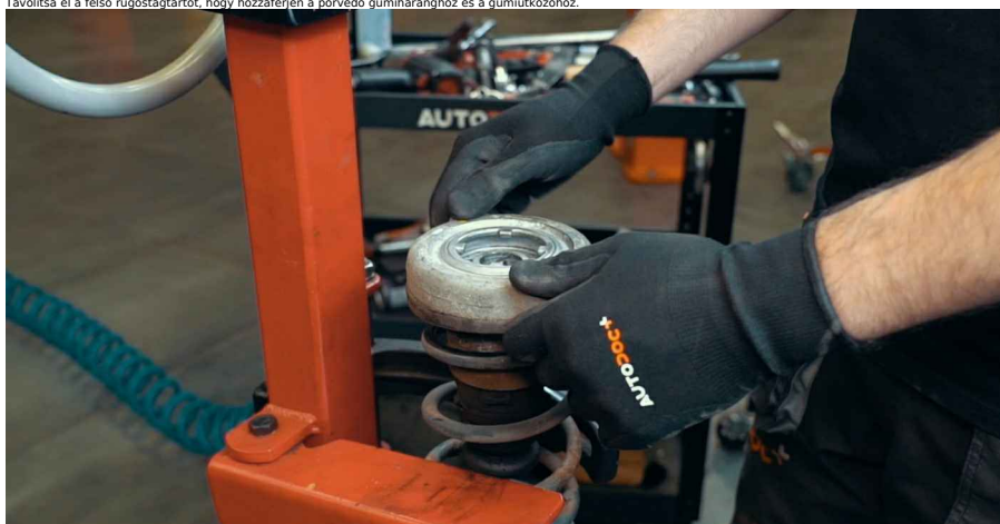
Figyelem! • Az gumiütköző vagy a dugattyúrúdra van szerelve, vagy a tartóhoz van rögzítve. • A porvédő gumiharang felszerelhető a gumiütközőre, felszerelhető a rugó és a tartó közé, vagy rögzíthető a tartóhoz.
