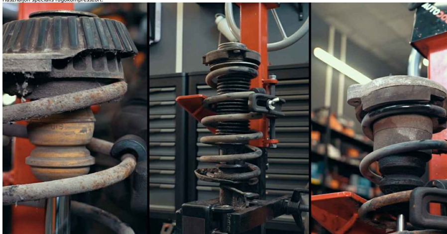
13 Távolítsa el a felső rugóstagtartót, hogy hozzáférjen a porvédő gumiharanghoz és a gumiütközőhöz.
