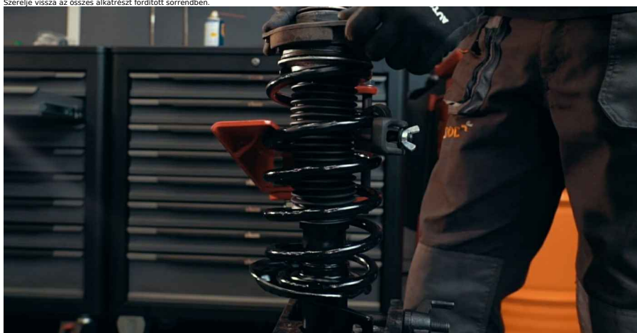
Fontos! • Figyeljen a rugóstag rögzítésének helyzetére, hogy az a megfelelő irányba nézzen.
