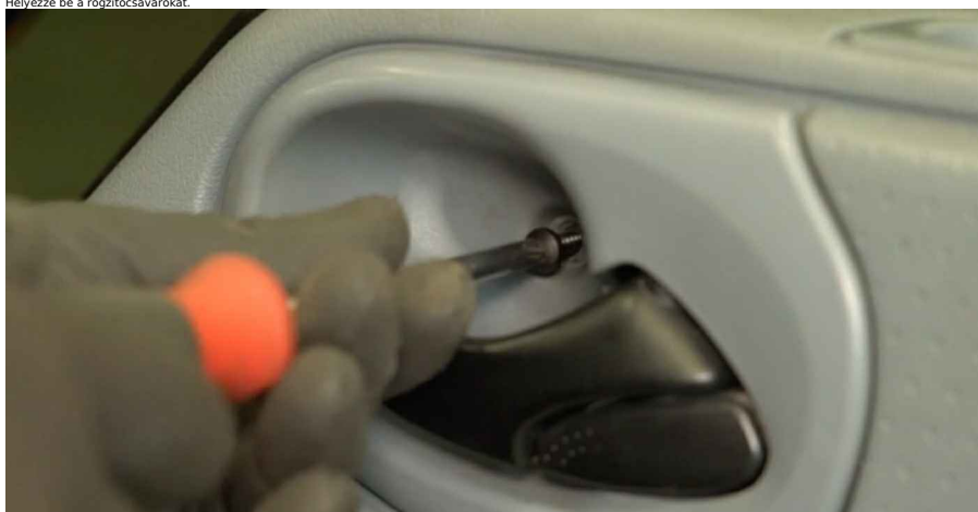
42 Húzza meg az ajtókárpit rögzítőelemét. Használjon csillagsavarhúzót.
