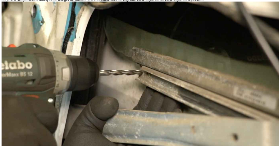
14 Fúrja ki a szegecseket, amelyek az ablakemelő mechanizmust az ajtóhoz rögzítik. Használjon fűrőt. Használjon fúrfejlesztet.
