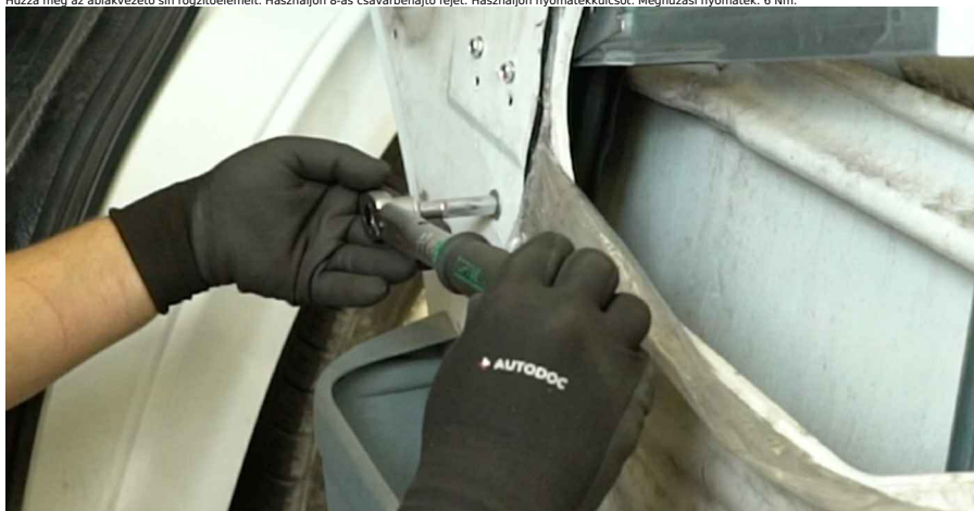
26 Üsse be a szegecsket, amelyek az üveget az ablakemelő mechanizmushoz rögzítik. Használjon szegecselőt. Használjon szegecsket.
