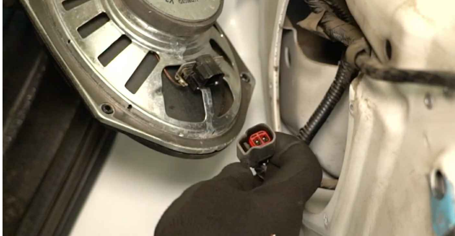
11 Távolítsa el a csatlakozót az elektromos ablakemelő motorjáról.
